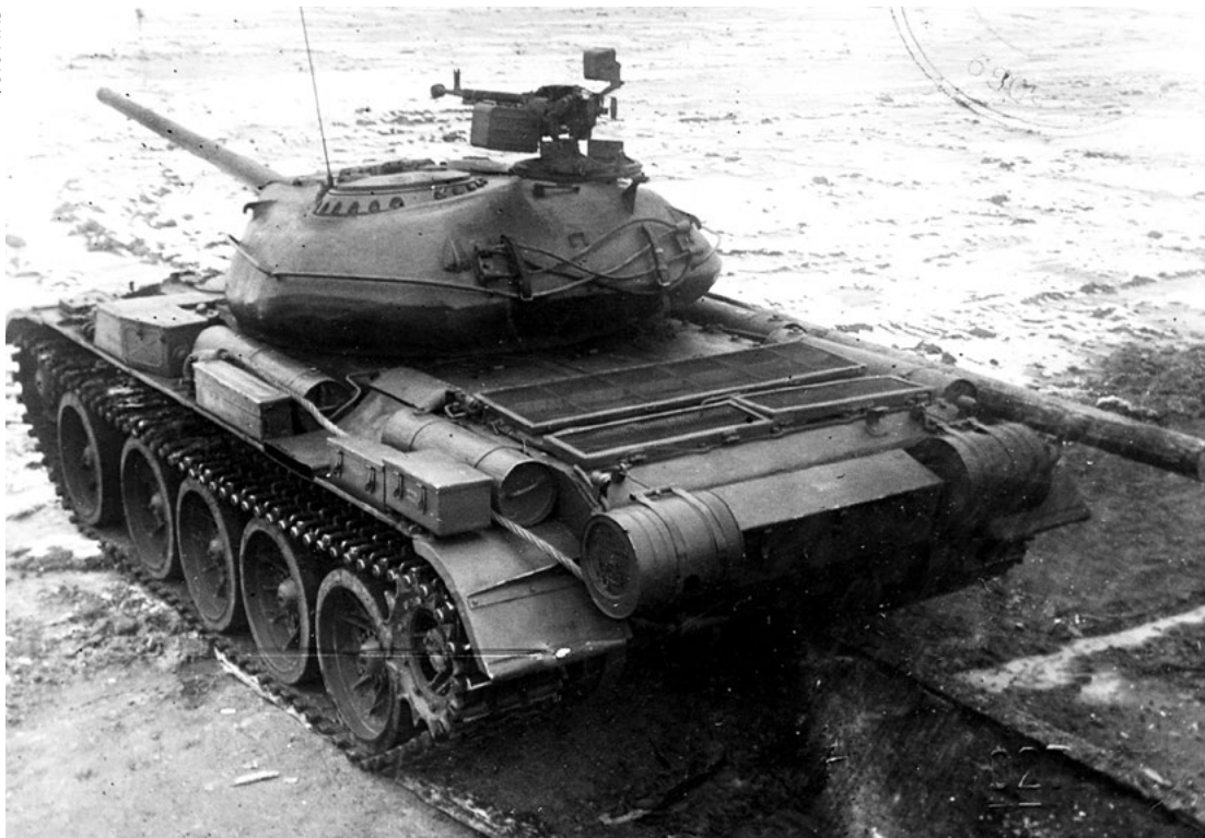
На кормовом листе Т-54 закреплены две дымовые шашки БДШ, а на надгусеничных полках видны цилиндрические топливные баки.
