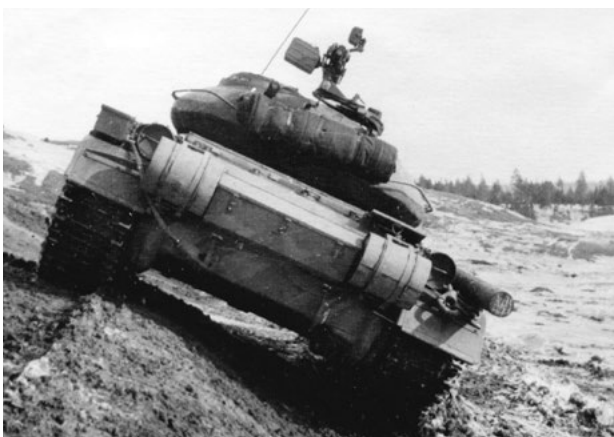
Движение танка по косогору во время одного из этапов испытаний.
