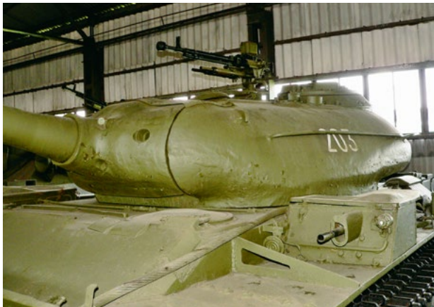
Характерной особенностью первых серийных Т-54 были курсовые пулемёты, установленные в ящиках на надгусеничных полках.
